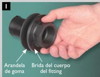
1. Retire la tuerca y la arandela de Baja Densidad Poli (la más firme de las 2 arandelas) del cuerpo del accesorio del estanque. Deslice el cuerpo del accesorio del estanque a través del agujero en el estanque. La arandela de goma debe estar siempre entre la brida del cuerpo del accesorio del estanque y la pared del estanque (asegúrese de que las "costillas" en la arandela de goma están sellándose contra la pared del estanque).
