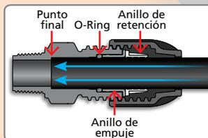
3. Inserte el tubo en la union a través de la tuerca, el anillo de retención blanco y el anillo de empuje hasta que encuentre resistencia en el O-Ring. Dele a la tubería un impulso firme más allá del o-ring hasta el punto final.
