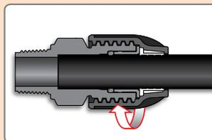
4. Apriete firmemente la tuerca con la mano. Use un par de empuñaduras en polietileno para darle media vuelta mas manualmente, para el ajuste final de accesorios de 40m y más.
