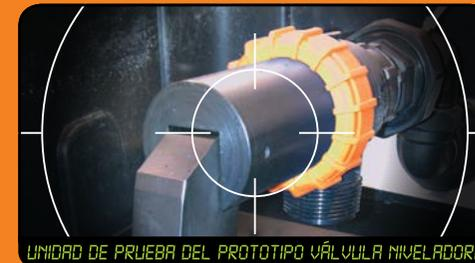
UNIDAD DE PRUEBA DEL PROTOTIPO VÁLVULA NIVELADORA
