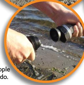
2. Una las dos partes enroscando la tuerca central común sobre el roscado macho.
