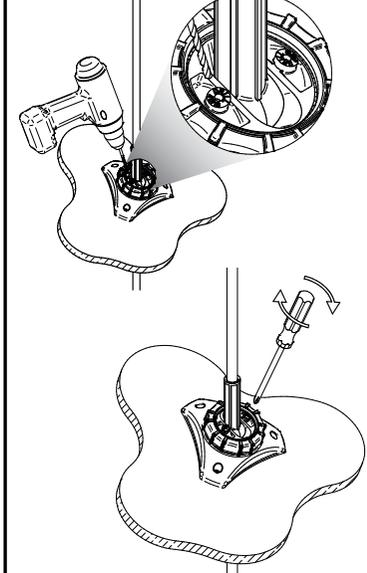
Perfore un agujero de 4 mm en cada una de los puntos de seguridad determinados, inserte los tornillos de seguridad y apriete.
