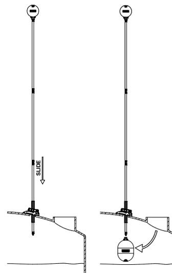
Deslice el tubo de acero inoxidable ensamblado a través de la guía del tubo de la base, llegando al interior del tanque y enganchando el flotador azul al otro extremo del tubo de acero inoxidable.
