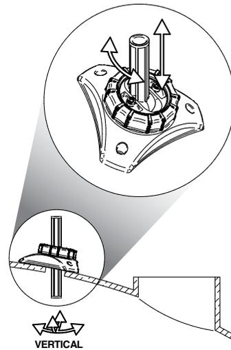
Ubique la base ensamblada UniTri en el agujero soltando la tuerca, levantando y rotando el tubo guía para alcanzar la posición vertical para a continuación apretar ligeramente la tuerca.
