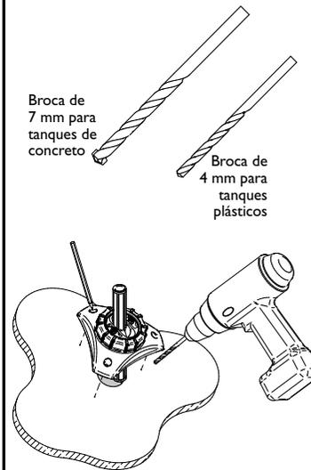
Broca de 7 mm para tanques de concreto
