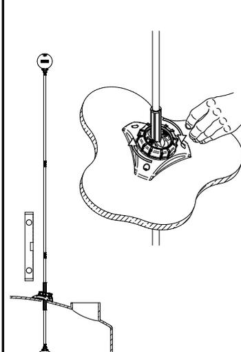
Con un nivel asegure se que el tubo de acero inoxidable esta aplomado verticalmente para entonces apretar manualmente la tuerca.
