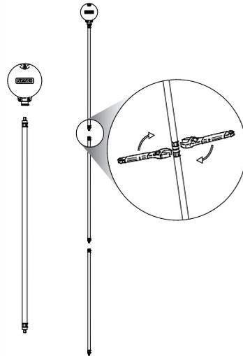
Atornille el flotador HiViz en una de las puntas roscadas del tubo macho-macho de acero inoxidable. Atornille el tubo adicional de acero inoxidable cuando así sea requerido al primer tubo para a continuación apretar todos los tubos con una llave adecuada.
