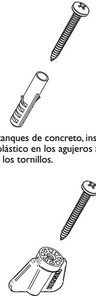
Para los tanques de concreto, inserte los tapones plástico en los agujeros antes de atornillar los tornillos.
