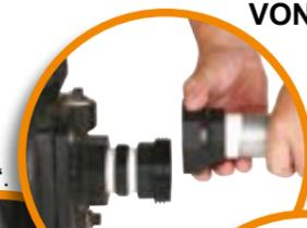
2. Verbinden Sie das neue Rohr mit der Pumpe, indem Sie die Mutter des entsprechenden Außengewindes festziehen.
