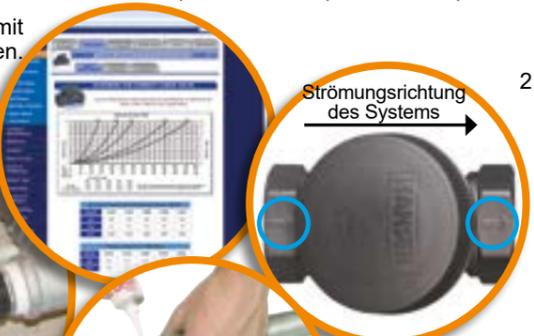
2. Bestimmen Sie die Strömungsrichtung des Systems, bauen Sie das Rückschlagventil so ein, dass die Pfeile auf dem Ventil in die Strömungsrichtung zeigen.
